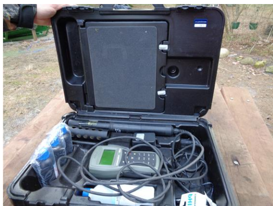
6.1. attēls. Hanna Instruments multiparametru zonde un ūdens fizikāli-ķīmisko parametru mērījumi ar to.
