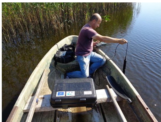
6.1. attēls. Hanna Instruments multiparametru zonde un ūdens fizikāli-ķīmisko parametru mērījumi ar to.
