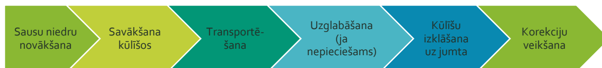
2.4. attēls. Niedru jumtu seguma ražošanas shēma.
