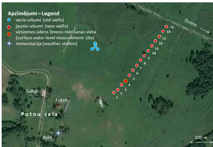
2. att. Gruntsūdens līmeņu monitoringa urbumu izvietojums Dvietes palienē (kartes dati © 2015 Google)
