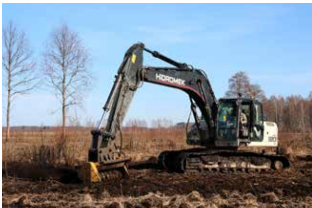
16., 17. att. Celmu frēzēšanas tehnika darbībā (13.03.2014.). Foto: I. Priedniece, E. Račinskis
