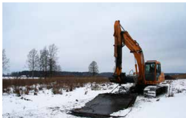
18. att. Stagnācijās vietās zem traktora kāpurķēdēm tika klātas metāla plāksnes (29.01.2015.). Foto: I. Priedniece
