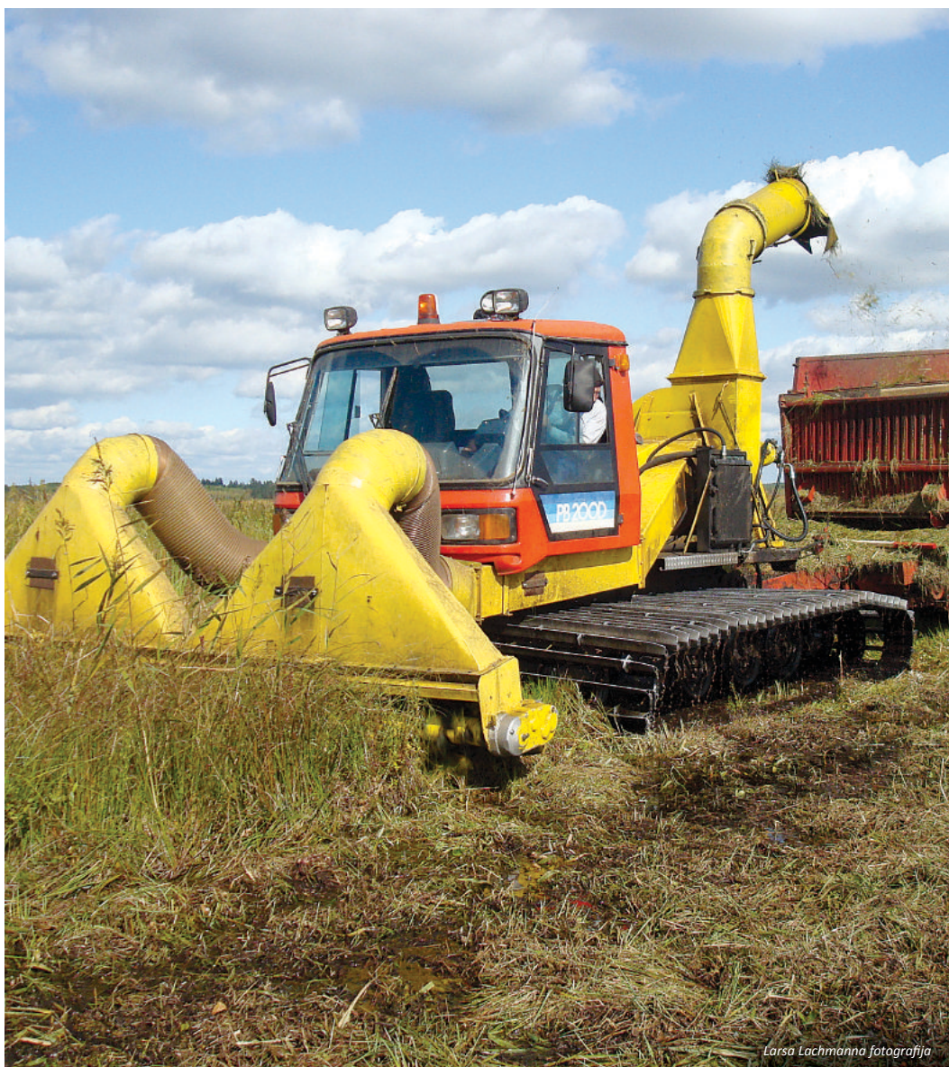
▲ Specializēts kāpurķēžu traktors purvu pļaušanai
